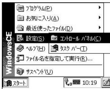
スタート メニューから設定、コントロールパネルを選択し、ディスプレイアイコンを軽く2度押してバックライトを設定します。
